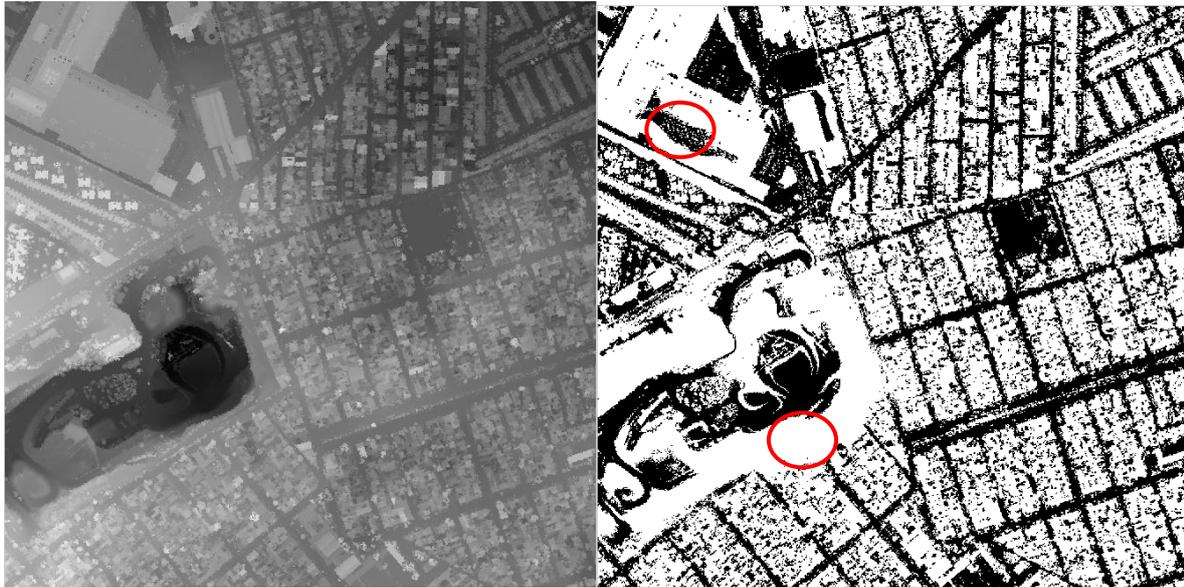
**Ilustración C-29. Ejemplo de filtrado fallido. A la derecha se muestra el modelo digital de elevación y a la izquierda la máscara de extracción de terreno (negro). Los círculos en rojo señalan los errores de filtrado.**
