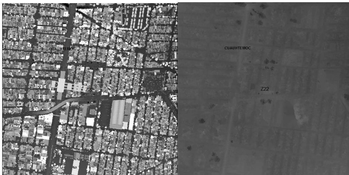
**Ilustración C-28. Ejemplo de filtrado de terreno. A la izquierda se muestra el modelo digital de terreno original y a la derecha el modelo de terreno desnudo generado.**
