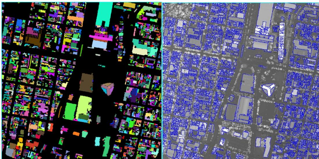
**Ilustración 12.** Ejemplo de extracción de edificios a partir de la segmentación del modelo digital de alturas. A la izquierda se muestra la segmentación y a la derecha, los polígonos generados superpuestos en el modelo.
